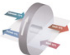
So funktioniert's: Ausströmende Luft gibt in den Geräten der Firma Klingenburg ihre Wärme an einströmende kalte Luft ab. Mit diesem Prinzip lassen sich die Heizkosten deutlich senken.
