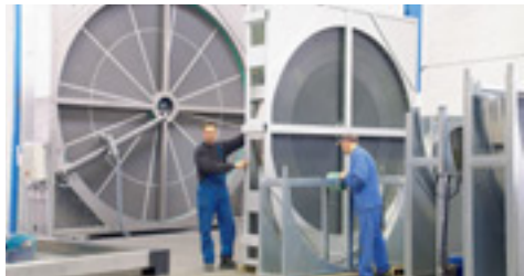
Imposante Größe: Mehrere Meter hoch sind die Wärmetauscher, die Klingenburg für die Industrie fertigt. Produkte aus Gladbeck kommen auch in riesigen Kreuzfahrtschiffen auf den Weltmeeren zum Einsatz.
