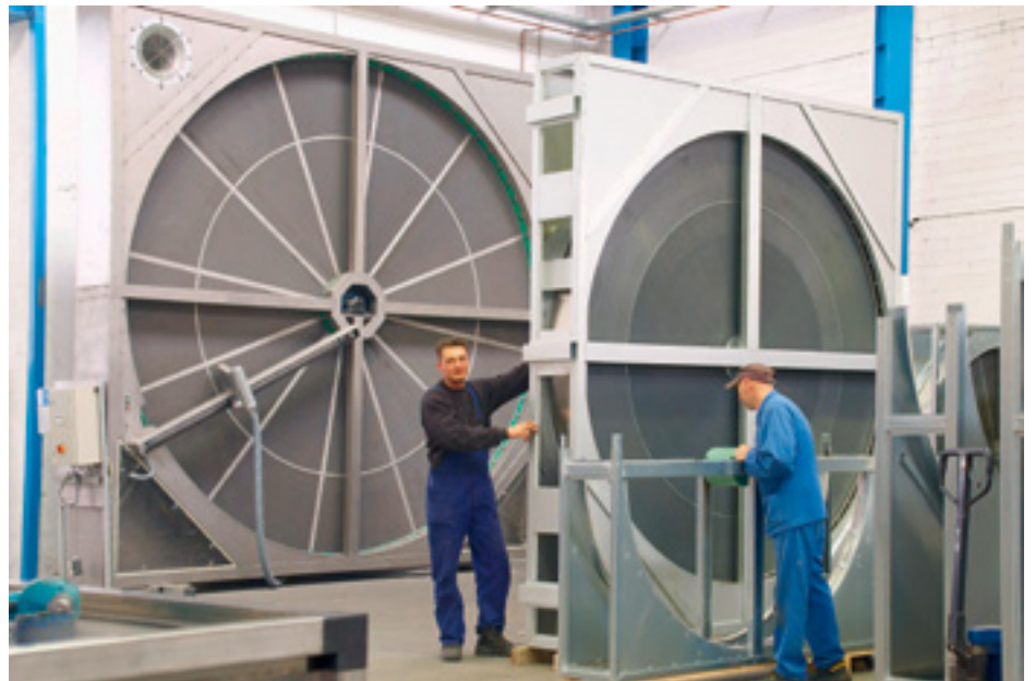
Abb. 1 // Rotationswärmetauscher (oben) Abb. 2 // Rotor in Be- und Entlüftungsanlage (unten)
